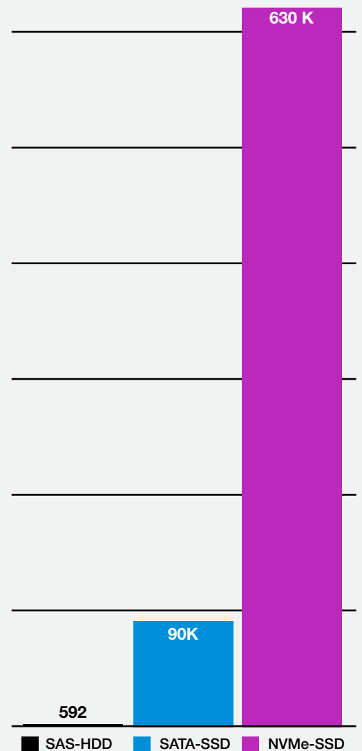
Abbildung 1: 4K Random Read IOPS für NVMe-SSDs sind 7-mal schneller als SATA-SSDs. 1
